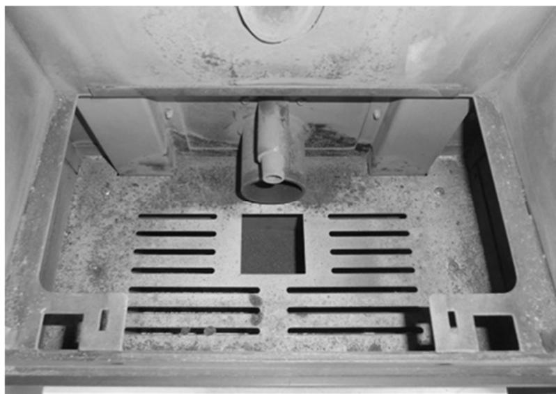
2本の筒が燃焼ポット受の穴に入るように燃焼ポット受を設置します。
