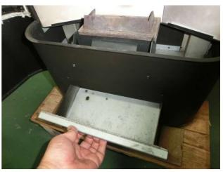
3. 灰受けの灰を不燃材で作られた容器に除去する。
