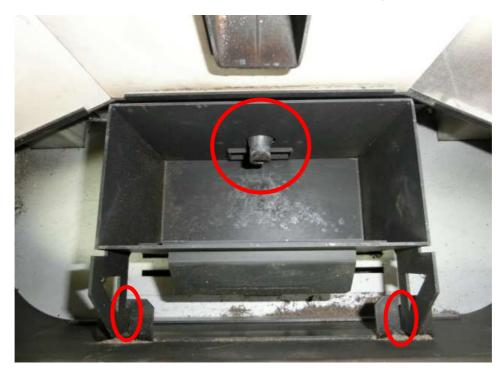
真ん中の細い筒が中央下部の穴に入るように燃焼ポットを設置します。 このとき燃焼ポットが傾かないよう注意してください。上から押さえてきちんと 安定する場所が正常な設置位置です。
